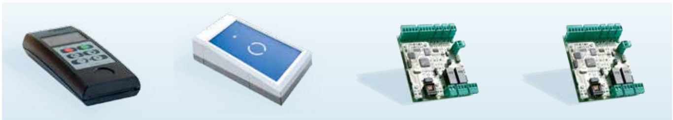
Das tragbare Programmiergerät ist ein Kommunikationsgerät zwischen dem PC und der Schliess-einheit.
